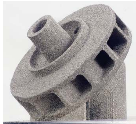
Fig. 15. Echantillons fabriqués sur le système PM100 de PHENIX SYSTEMS : a - échantillon fabriqué pour définir le degré de précision de la reproduction de la géométrie; b - turbine de pompe.
