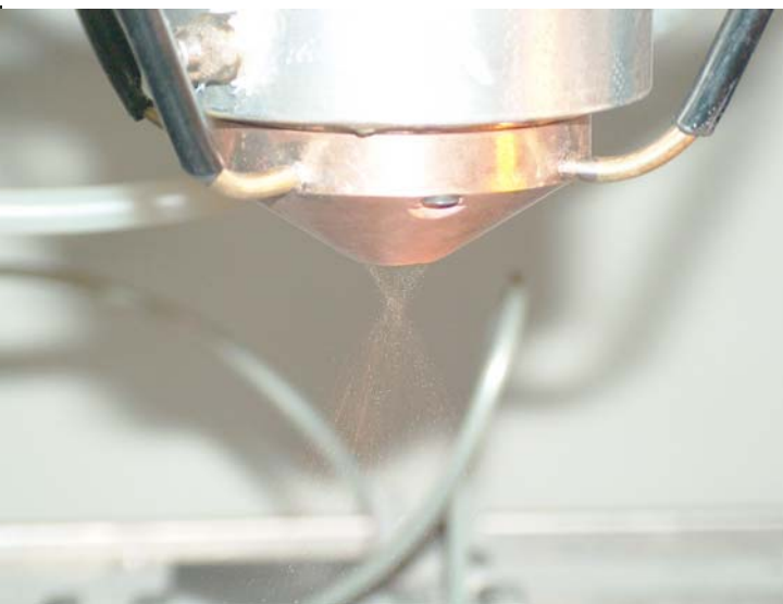
Optique de rechargement-fabrication directe par injection coaxiale de poudres
