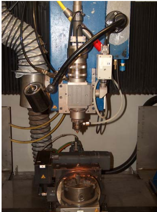
Optique de rechargement-fabrication directe par injection coaxiale de poudres
