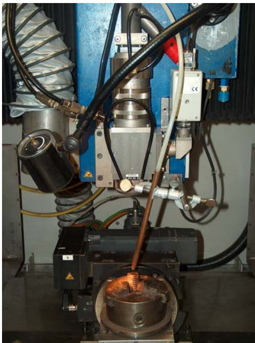
Optique de rechargement-fabrication directe par injection coaxiale de poudres
